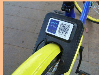
自転車についているQRコードをスキャンすると鍵が開く仕組み。
