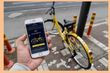
自転車についているQRコードをスキャンすると鍵が開く仕組み。
